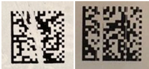
Нарушение целостности КМ*
